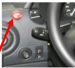
1 Not-Aus-Taster links neben dem Lenkrad betätigen
