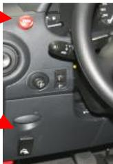
Bedienelement zum Öffnen der Ladeklappe
